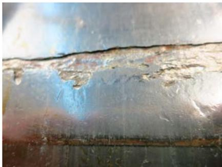
Hauptlagerschaden, Ursache Korrosion (betriebsbedingter Fehler). Foto: J. Holzmüller
