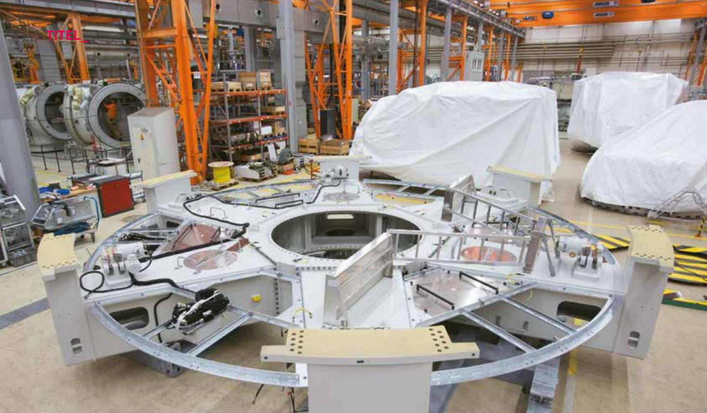
**Montage des Statorträgers** eines EP4-Generators bei RoAn in Magdeburg-Rothensee.
