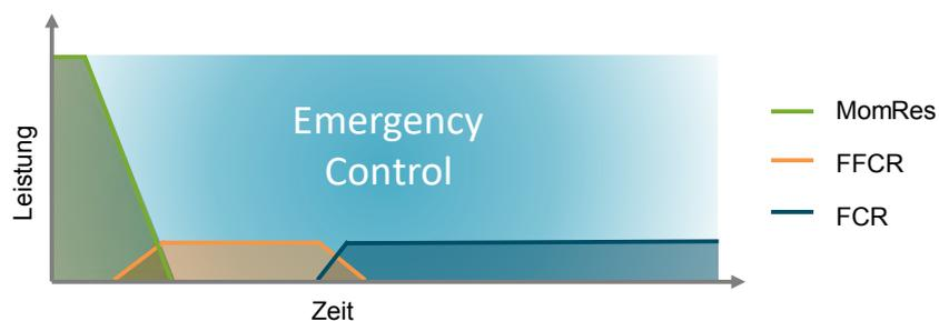
Abbildung 6-10: Mögliche Ausgestaltung der SDL zur Frequenzhaltung im Falle eines System-Split-Ereignisses
