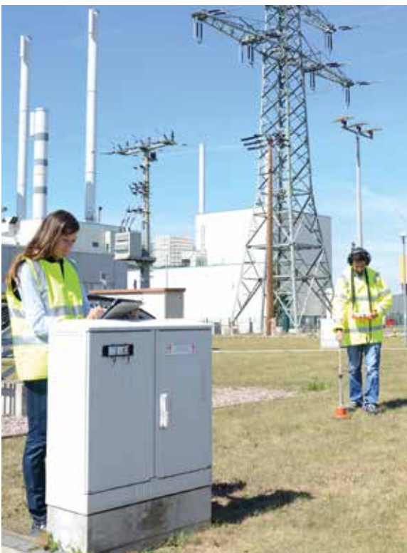
Bild 7: Das digiPHONE+ NT Set unterstützt die schnellstmögliche Kabelfehlernachortung mit SmartFuse250 und macht sie wirtschaftlich.
