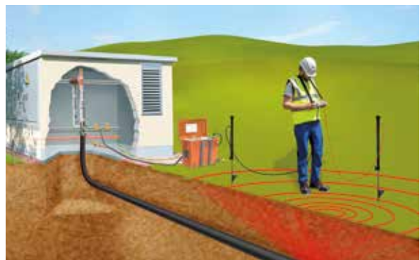
Bild 6: Präzise Nachortung von Mantelfehlern mit der Schrittspannungsmethode
