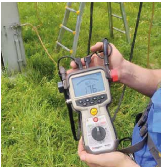
Bild 5: Das MOM2 von Megger hat sich in der Praxis als ideales Mikroohmmeter bewährt
