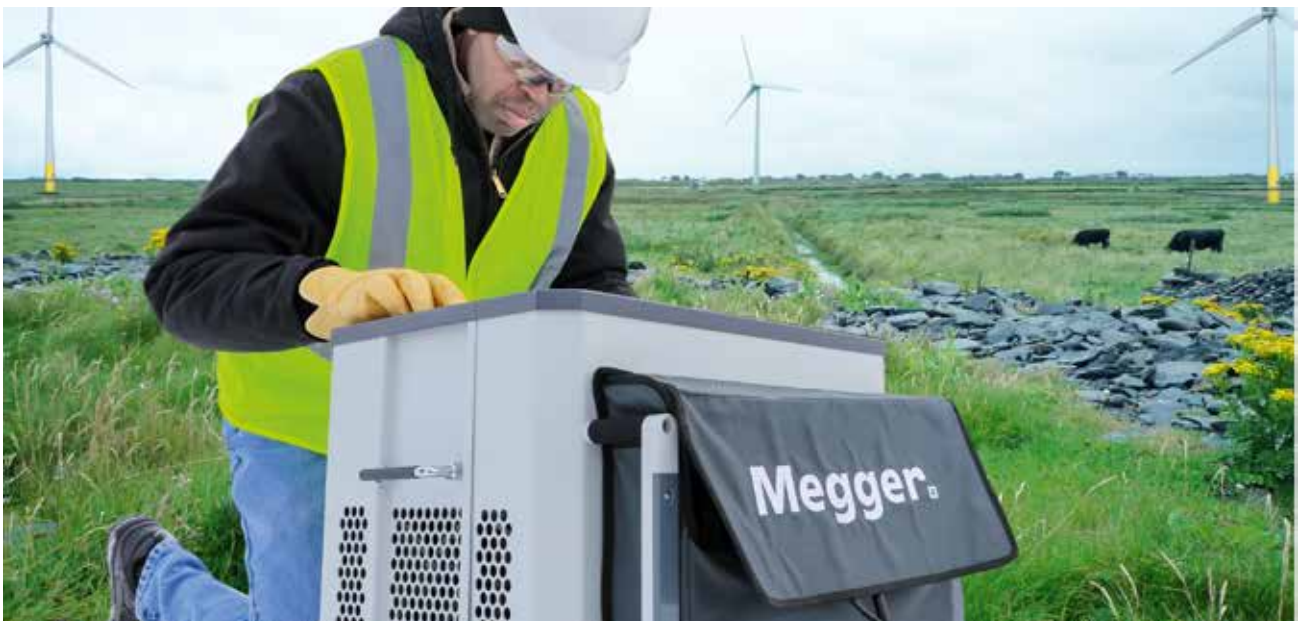
Bild 1: Kompakter und leichter geht es derzeit nicht. Kabelprüfanlage VFL Sinus 62 mit integrierter Tan-Delta-Messung
