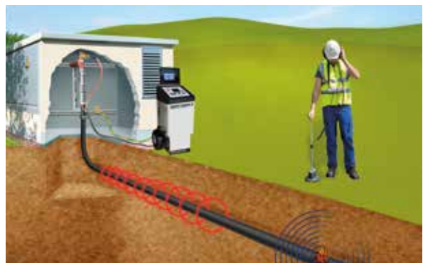
Bild 5: Kabelfehlernachortung mit Bodenschallsensor für die schnellst mögliche Ortung
